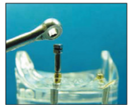
5. 再以扳手鎖到20Ncm的扭力值
